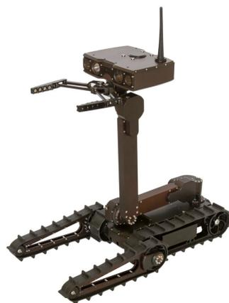
Мобильный робот оснащен манипулятором типа "рука" с универсальным захватом для объектов. Манипулятор позволяет использовать робота для работы с различными предметами как в автономном/автоматическом режиме, так и в режиме телеприсутствия.
